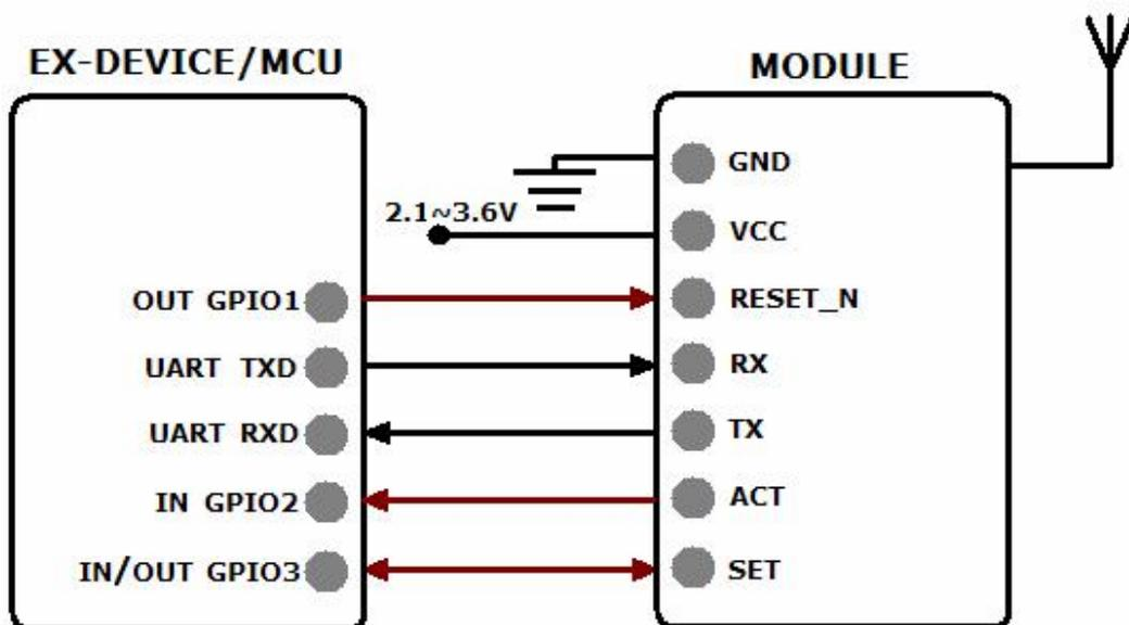
可以通过控制无线模块的 **RESET\_N** 和 **SET** 引脚来实现模块工作模式的选择。其中，**RESET\_N** 为模块的输入复位引脚，低有效；**SET** 引脚会在模块上电、复位一瞬间自动设置为输入引脚并有弱上拉。若 **SET** 引脚此时被拉低模块会进入配置模式，进入配置模式后该引脚一直会保持为输入引脚；若 **SET** 引脚在模块上电、复位为高电平，则会进入正常工作模式，该引脚会被作为输出引脚使用用来指示模块的内部的缓冲区的空闲状态。
