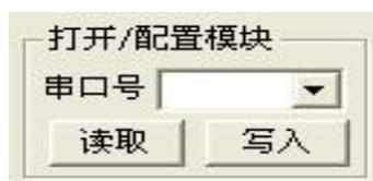
在“打开/配置模块”框里选择配置板对应的串口号，点击“读取”和“写入”按钮就可以读写模块的配置块。配置工具能够自动检测配置板从电脑 **USB** 口的插入和拔出，并给出相应的提示信息。
