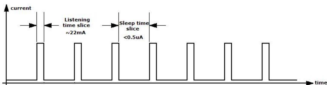
该参数的取值范围为 **0~2500**。模块接收时的电流为 **22mA**，休眠时为 **0.5uA**，占空比为 **0~2500** 范围的待机电流为 **22mA~9.3uA**。在实际使用中关心的是实际使用平均功耗而非待机电流。“睡醒比”越大，模块的待机电流就越小但同样意味着唤醒休眠模块需要的时间越长、模块的响应速度越慢，每个报文的平均发送时间越长。因此“睡醒比”参数的设置需要综合考虑实际网络的使用情况，使得实际使用平均功耗最低。
