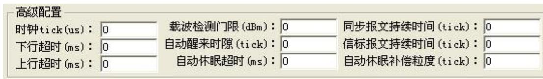
在点开 **高级选项** 按钮在配置工具对话框的底部就会出扩展的高级配置选项，如上图所示。在这里可以配置时钟周期、载波检测门限、自动休眠超时、自动醒来间隙、上下行的超时时间、以及同步报文和信标报文的持续时间等参数。
