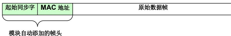
对于下行数据，节点模块会自动丢弃额外的帧头，并向外设发送原始数据帧。因此，对于外设来说对这个额外的帧头毫无知觉。虽然模块的 **MAC** 地址默认只有 **6** 字节，但是用户仍然可以设置 **MAC** 地址字段的长度为 **1~16** 字节。模块的 **MAC** 地址可以通过配置软件进行修改。
