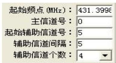
“起始频点”设置信道号为 0 的频率，模块的信道间隔为 200KHz。对于信道号为 N 的信道的频点为： $\text{Freq} = \text{“起始频点”} + (\text{N} \times 200\text{KHz})$ 。第 M(从 0 开始)个辅助信道的信道号 N 的计算公式为： $\text{N} = \text{“起始辅助信道号”} + (\text{M} \times \text{“辅助信道间隔”})$ 。辅助信道的个数可以设置为 1, 2, 4, 8, 16。不同的 RF 波特率需要的大致带宽如下表所示：
