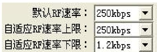
通过这三个下拉选项框设置 **RF** 默认波特率、**RF** 自适应波特率上限和 **RF** 自适应波特率下限。模块支持 **12** 种 **RF** 波特率：**500k, 250k, 175k, 100k, 76.8K, 38.4k, 19.2k, 9.6k, 7.2k, 4.8k, 2.4k** 和 **1.2kbps**。“默认 **RF** 速率”是指节点之间在进行握手（短报文）时采用的速率；“自适应 **RF** 速率上限”和“自适应 **RF** 速率
