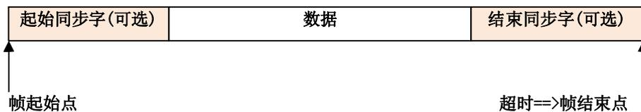
**说明：**在二进制模式“报文长度偏移量”和“报文长度修正值”两个参数均为 **255**（无效值）的情况下，即使使能了帧结束同步字的判断，对报文结束的边界的判断只能依赖超时判断为依据。这时使能帧结束同步字的判断的目的是为了检测超时判断的准确性。
