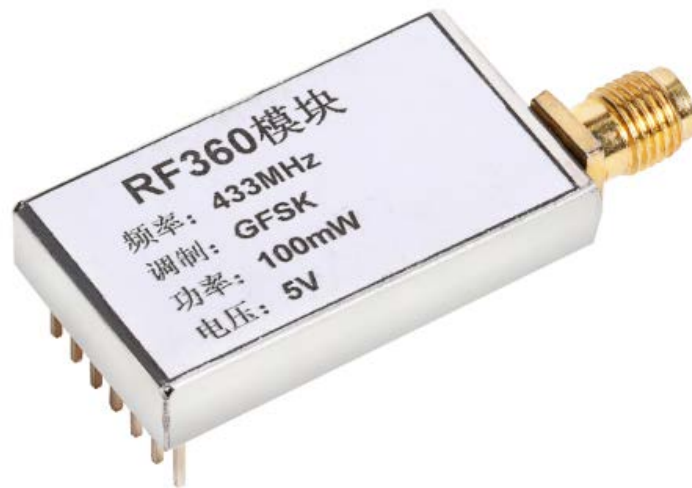
图一: RF360 小功率低功耗无线数传模块实物图
