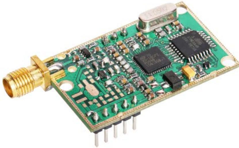
图一：BM200 微功率无线数传模块实物图
